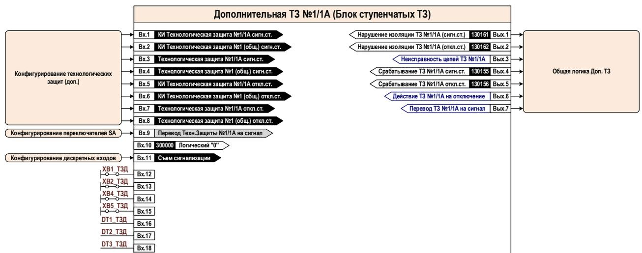
Рисунок 2.60 – Блок-схема дополнительной технологической защиты №1/№1А
