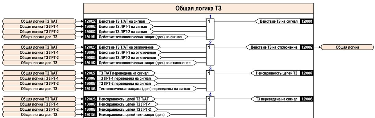
Рисунок 2.65 – Блок-схема общей логики технологических защит
