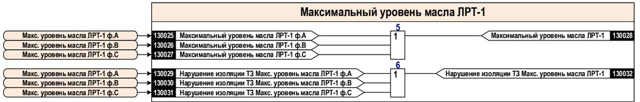
Рисунок 2.45 – Блок-схема общей логики ТЗ максимального уровня масла ЛРТ-1
