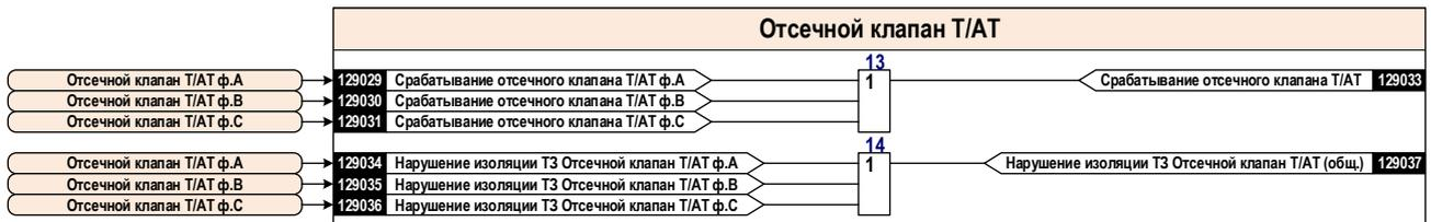
Рисунок 2.22 – Блок-схема общей логики Т3 отсечного клапана Т/АТ
