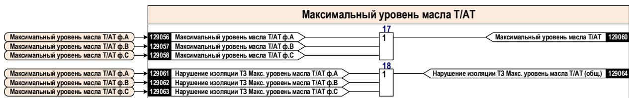
Рисунок 2.26 – Блок-схема общей логики Т3 максимального уровня масла T/AT
