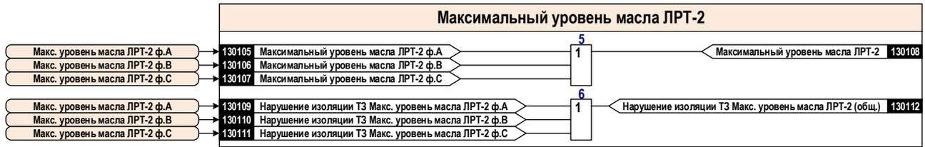
Рисунок 2.55 – Блок-схема общей логики Т3 максимального уровня масла ЛРТ-2
