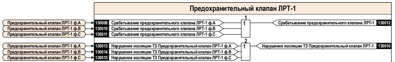
Рисунок 2.41 – Блок-схема общей логики ТЗ предохранительного клапана ЛРТ-1
