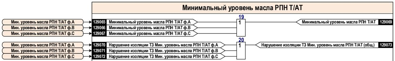
Рисунок 2.28 – Блок-схема общей логики Т3 минимального уровня масла РПН Т/АТ
