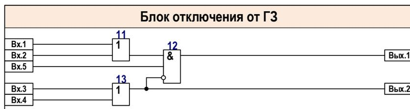
Рисунок 2.7 – Логическая схема блока отключения от ГЗ
